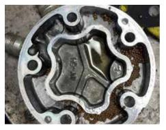
L'utilisation de **filtres non authentiques** peut entraîner la pénétration de particules de charge dans le système et le **blocage** et le **dysfonctionnement** ultérieurs des éléments du système, **jusqu'à la panne** du compresseur
