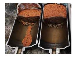
La quantité de remplissage dans un filtre non authentique prend **moins de**1/3 du volume du filtre, ce qui réduit significativement ses ressources et sa capacité à éliminer l'humidité et les impuretés nuisibles
