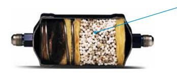
Certains déshydrateurs non authentiques utilisent une charge granulaire. Les granules de charge se frottent les uns contre les autres pendant la vibration ou pendant le passage du fluide frigorigène, provoquant donc le risque de fines particules de pénétrer dans le système
