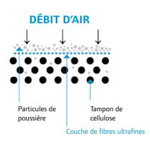
Les filtres Thermo King ont un diamètre de fibre de moins d'un micromètre et de petits espaces entre les fibres. Cela fournit une grande capacité de filtrage (la capacité d'accumuler une grande quantité d'impuretés, ou de fonctionner longtemps sans remplacement) sans augmentation significative de la résistance.
