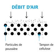
Les fibres de cellulose dans un filtre non authentique présentent de grands écarts entre elles, ce qui permet aux contaminants de pénétrer profondément dans le filtre et de bloquer le débit d'air. Cet effet entraîne une augmentation de la résistance du filtre à mesure que la saleté s'accumule.
