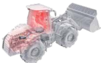
Chauffage à eau
