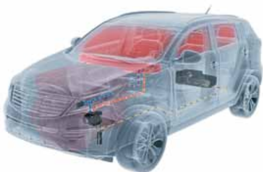
Chauffage à eau
