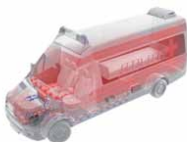
Chauffage à eau
