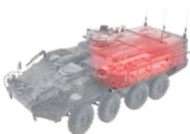
Chauffage à air
