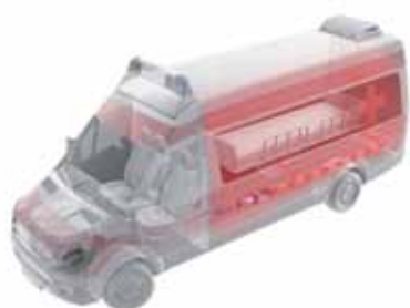
Chauffage à air
